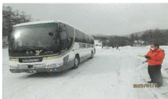
急ブレーキ使用時のスリップ距離測定(速度指定)
